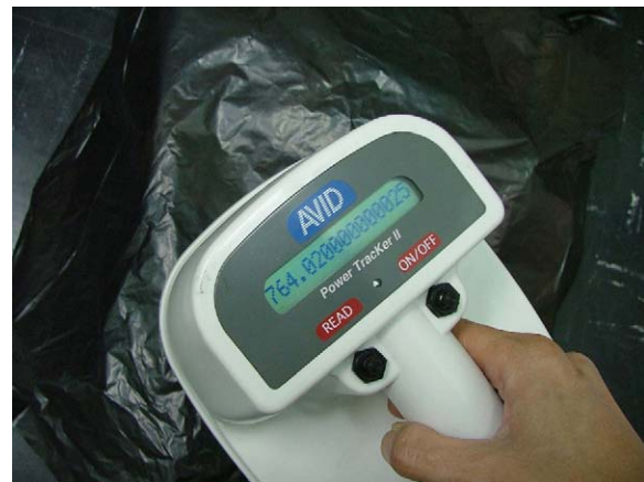
Fig. 3. PowerTracker II RFID chip reader.
