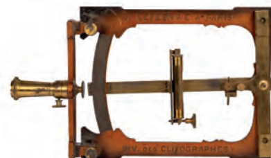
1225 Clitógrafo en bronce dorado de la manufactura de Jules Lefebvre. Utilizado por arquitectos y similar para la medición de ángulos en inclinaciones. Pp. S. XX.
