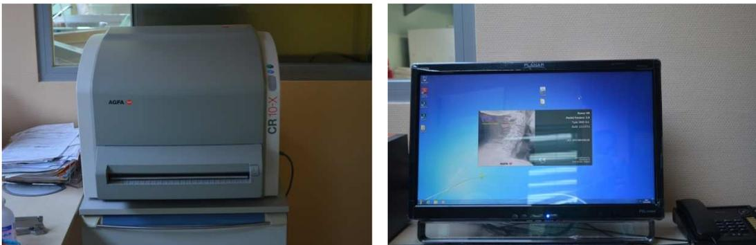
*Digitalizador modelo "AGFA CR 10 - X" y Estación de trabajo modelo "NX"*
